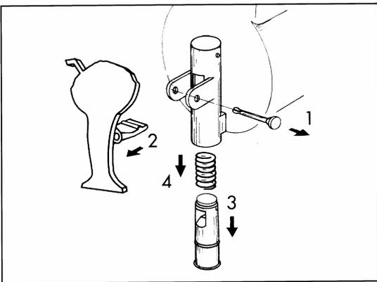
Zapfventil gemäß nebenstehender Zeichnung zerlegen und alle Teile gut waschen. Nach dem Trocknen den Zapfen (Pos. 3) mit Vaseline einfetten und Ventil in umgekehrter Reihenfolge wieder zusammenbauen.
