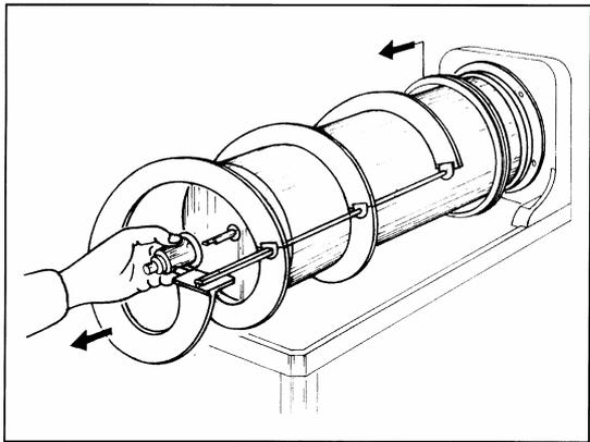
Schnecke, Saugdichtung und Behälterdichtung nach vorn abnehmen. Alle Teile gründlich in warmem Wasser waschen.
