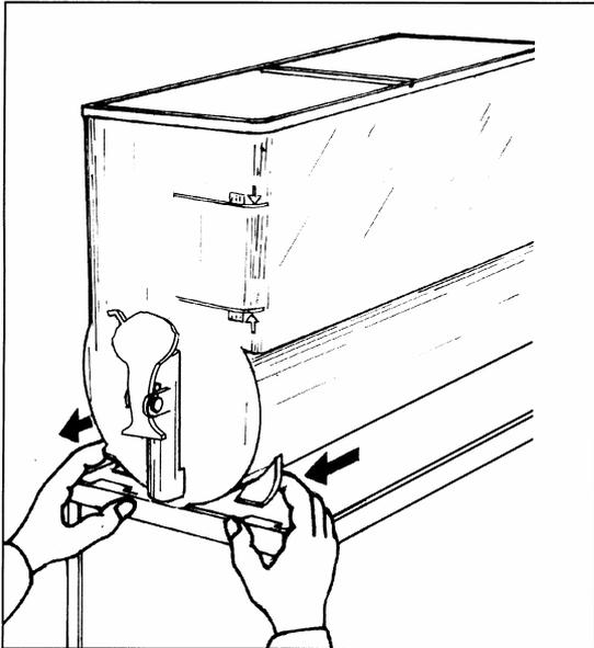
Behälter nach vorn abziehen und in lauwarmem Wasser gut auswaschen. Kein Scheuerpulver oder aggressive Reinigungsmittel verwenden.
