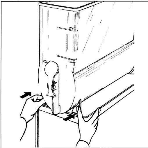
Behälterdichtung oder Behälter gut anfeuchten , dann Behälter aufsetzen und kräftig nach hinten drücken.
